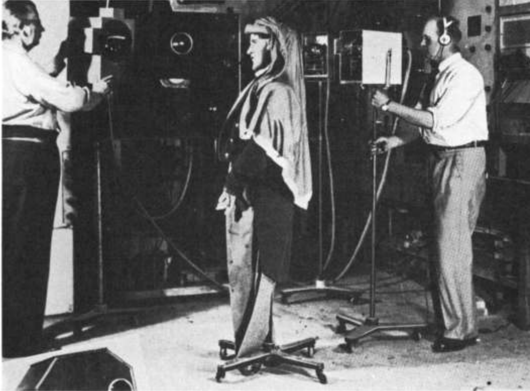
Lichtpunktabtaster von Baird. Wieder dient eine Puppe als Modell (Bild: Tiltman).
