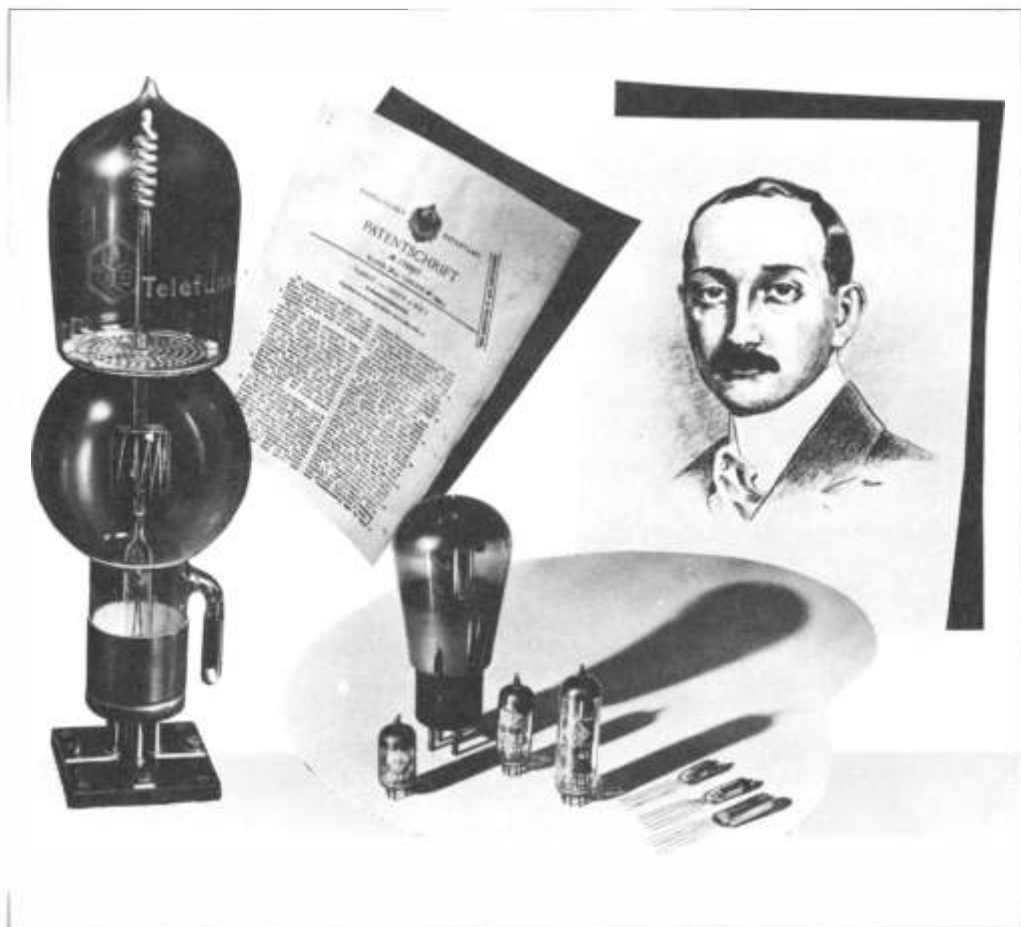
63 Robert von Lieben, der in den Jahren 1906–1912 die Verstärkerröhre erfand, eines seiner Pionierpatente und eine von der AEG 1912 für Telefunken hergestellte erste »Verstärkerlampe«. Bescheiden war ihre Verstärkung, riesig die Abmessungen im Vergleich zu ihren heutigen Abkömmlingen.
