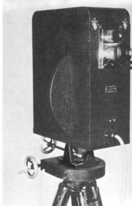
Barthélémys „bewegliche“ Kamera mit Nipkowscheibe für 90 Zeilen, 1933.
