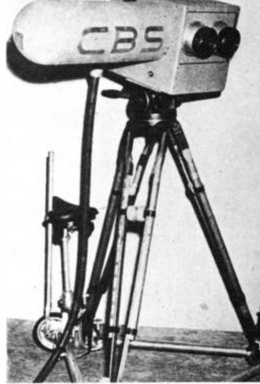
Kamera für das CBS-Farbfernsehsystem.
